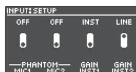
4. Gire los mandos [1] (MIC1)/[2] (MIC2) para ajustar PHANTOM en la posición de "ON".
