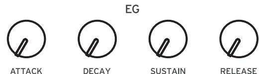
tro y la velocidad o intensidad del LFO. La señal de EG está disponible en el mando PITCH EG INT de la sección VCO 2 MODULATION, en el mando EG INT de la sección FILTER y en el conmutador EG MOD de la sección LFO. Este conmutador se puede ajustar para permitir que la señal del EG controle la velocidad (RATE) o la intensidad (INT) junto con los mandos RATE e INT de la sección LFO.
